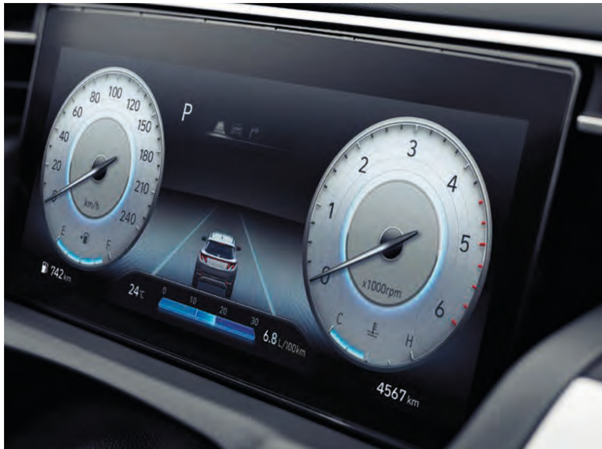
Panel de instrumentos digital de 10,25". Modo Normal
