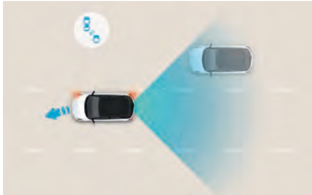
Sistema activo de detección de ángulo muerto (BCA). Mediante sensores situados en la parte inferior del parachoques trasero y una cámara frontal, el sistema te avisa de los vehículos que se acercan por la zona del ángulo muerto. Si activas el intermitente en esa dirección, el sistema emite una señal acústica y activa el freno para evitar la colisión.
