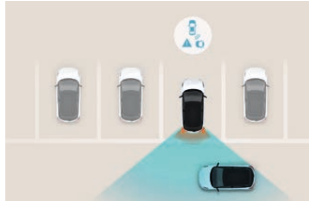
Alerta de aproximación de tráfico trasero activo (RCCA) Al dar marcha atrás en zonas de poca visibilidad, el sistema avisa al conductor si se aproximan vehículos por el lateral y activa los frenos de forma automática en caso de detectar una posible colisión.
